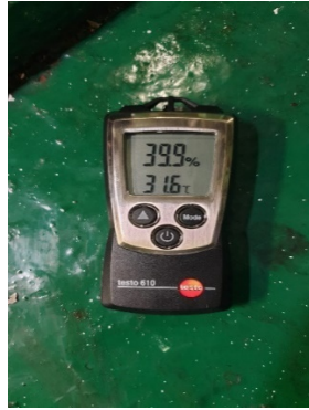
Slika 17. Testo 610 - uređaj za mjerenje vlage i temperature
