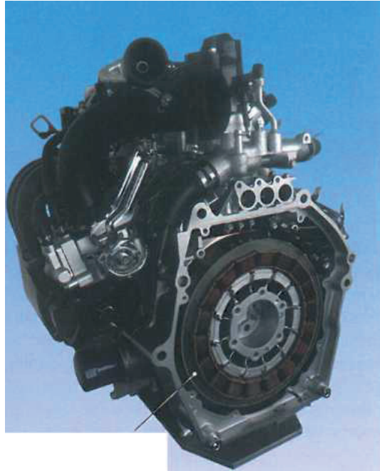
Slika 5.8. Ugradnja elektromotora između motora i mjenjača [50]
