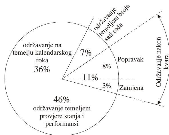
Slika 29. Udio pojedinih tipova održavanja sustava broda [56]
