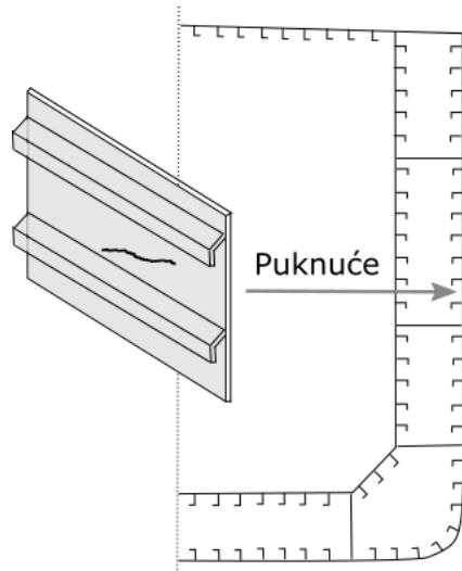
Slika 39. Analizirani detalj broda s označenim područjem oštećenja
